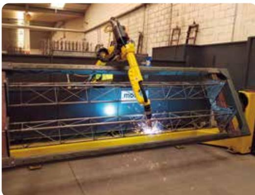
Soldadura por brazo robótico
